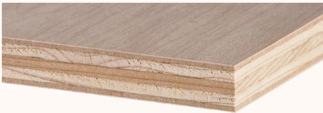
Bien que le Classic Core respecte toujours la tolérance d'épaisseur HP-1 de +0 / -3/64", les croisillons en MDF techniques offrent des tolérances d'épaisseur plus homogènes par rapport à une construction à noyau tout-placage à une seule étape. Les épaisseurs standard des panneaux Classic Core incluent 1/2", 5/8", 3/4", 19,5 mm, 1" et 1 1/4".
